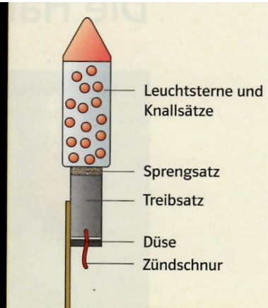
3 Aufbau eines Feuerwerkskörpers
